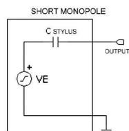
Come detto, il monopolo è assimilabile ad un condensatore di bassa capacità: 10÷20 pF.
